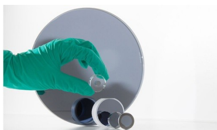
図 異なる光学基板に貼りつけられた結晶干渉コーティング(© 2018 Georg Winkler, Universität Wien)
